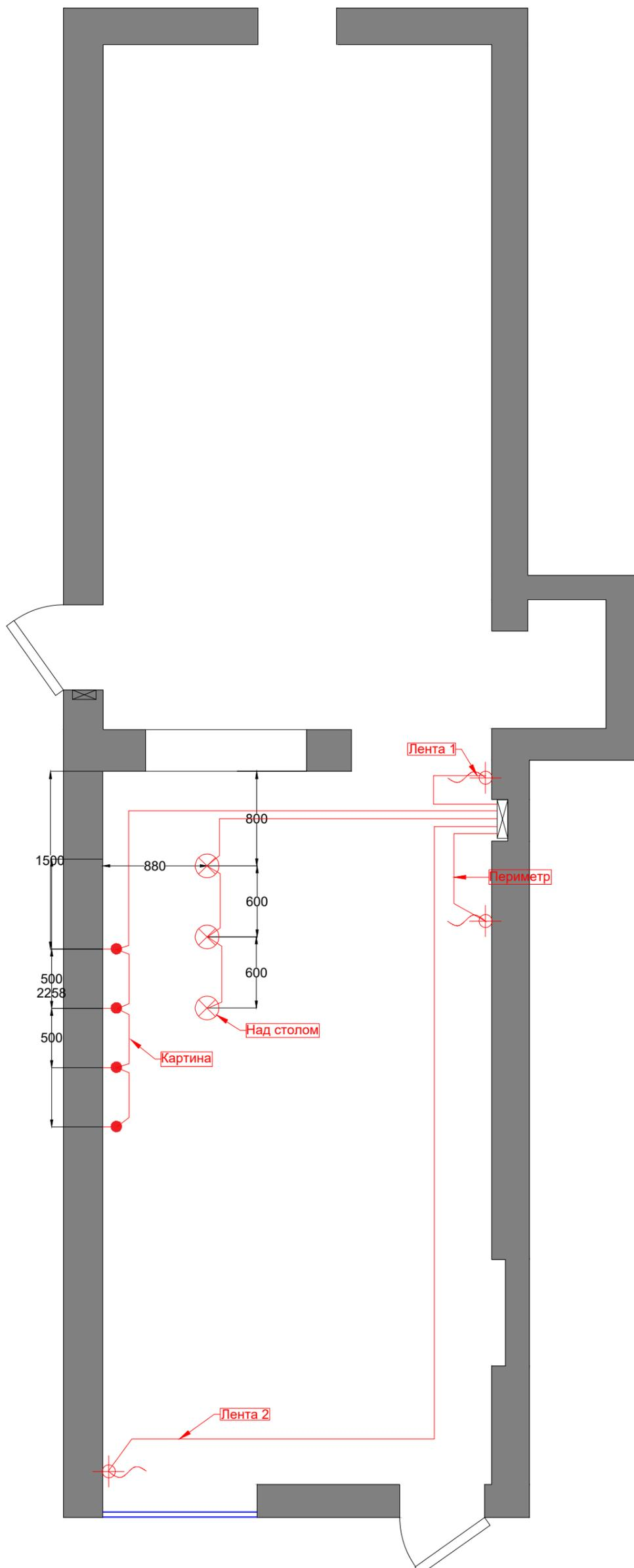
Освещение монтируется кабелем ВВГнг-LS 3х1.5
