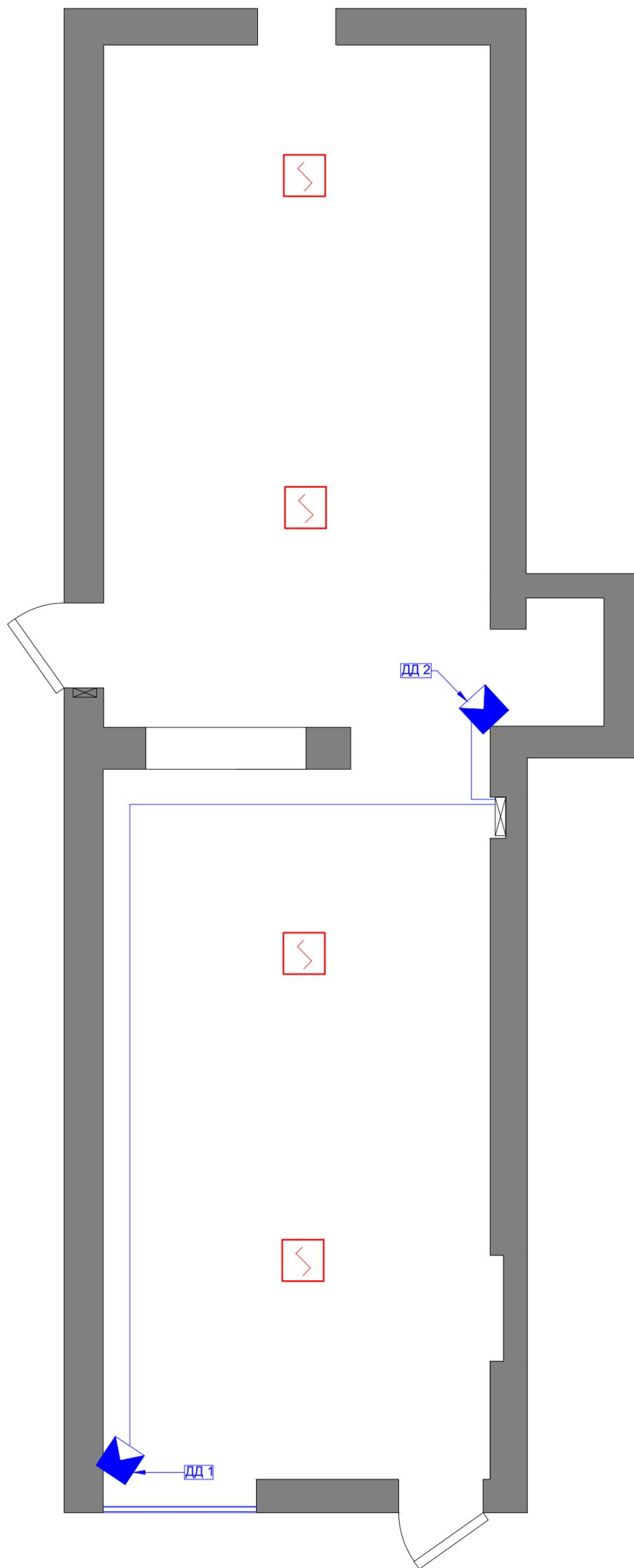
Датчики движения монтируются кабелем ES-04
