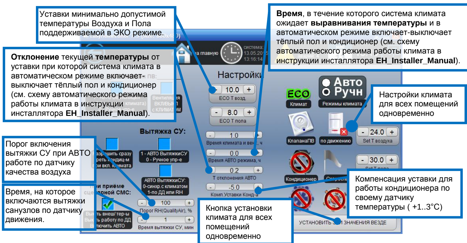
Рисунок 12 – Страница «Отопление - Настройки»
